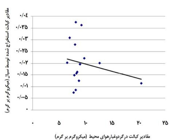
نمودار ۱- تغییرات مقدار بیون‌های فلزی کادمیوم، کربالت، کروم و نیکل استخراج شده توسط سیال نسبت به مقدار آن در گرد و غبار هوا
