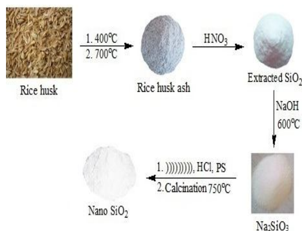
شکل 1- سنتز نانوذرات سیلیکات از پوسته برنج
