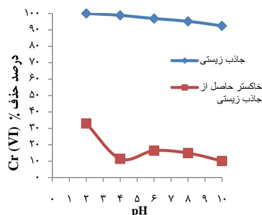
نمودار ۱- اثر pH محلول در راندمان حذف کروم شش ظرفیتی. (دوز جاذب:  $8\text{g/lit}$ ، غلظت اولیه کروم:  $20\text{mg/lit}$ ، زمان تماس:  $60\text{min}$ ، سرعت اختلاط:  $300\text{rpm}$ ، دما:  $25^\circ\text{C}$ ).
