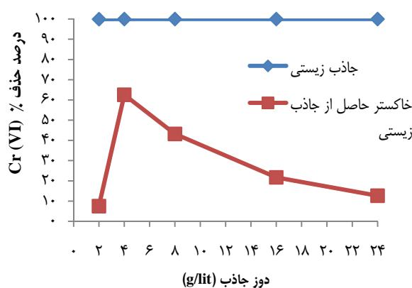
نمودار ۳- اثر دوز جاذب زیستی پوسته سبز بادام و خاکستر آن در راندمان حذف کروم شش ظرفیتی. ( $\text{pH}=2$ ، غلظت اولیه کروم:  $20\text{mg/lit}$ ، زمان تماس:  $60\text{min}$ ، سرعت اختلاط:  $300\text{rpm}$ ، دما:  $25^\circ\text{C}$ ).
