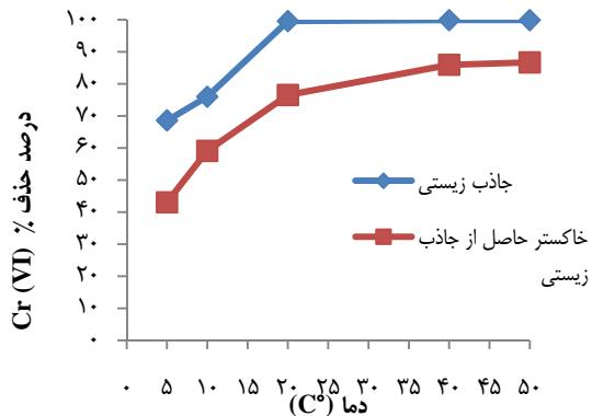
نمودار ۸- اثر دما در راندمان حذف کروم شش ظرفیتی توسط جاذب زیستی پوسته سبز بادام و خاکستر آن. جاذب زیستی: (pH=۲، دوز جاذب: ۲g/lit، غلظت اولیه کروم: ۲۰mg/lit، زمان تماس: ۶۰min، سرعت اختلاط: ۳۰۰rpm). خاکستر حاصل از جاذب زیستی: (pH=۲، دوز جاذب: ۴g/lit، غلظت اولیه کروم: ۲۰mg/lit، زمان تماس: ۶۰min، سرعت اختلاط: ۶۰min).
