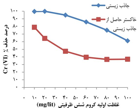
نمودار ۶- اثر غلظت اولیه کروم در راندمان حذف کروم شش ظرفیتی توسط جاذب. جاذب زیستی پوسته سبز بادام؛ pH=۲، دوز جاذب: ۵g/lit، زمان تماس: ۶۰ min، سرعت اختلاط: ۳۰۰ rpm. خاکستر حاصل از جاذب زیستی: pH=۲، دوز جاذب: ۴g/lit، زمان تماس: ۶۰ min، سرعت اختلاط: ۳۰۰ rpm.
