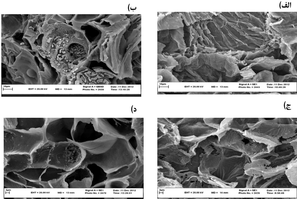
شکل ۱- میکروگراف گرفته شده توسط میکروسکوپ الکترونی از جاذب زیستی پوسته سبز بادام و خاکستر آن. (الف) جاذب زیستی، قبل از تماس با کروم، بزرگنمایی  $2/5\text{ kx}$ . (ب) جاذب زیستی، بعد از تماس با کروم، بزرگنمایی  $2/5\text{ kx}$ . (ج) خاکستر جاذب، قبل از تماس با کروم، بزرگنمایی  $5\text{ kx}$ . (د) خاکستر جاذب، بعد از تماس با کروم، بزرگنمایی  $5\text{ kx}$ .
