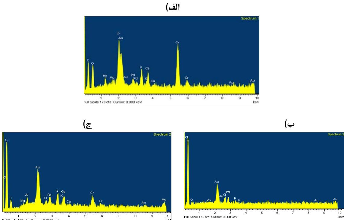
شکل ۲- تصویر EDX از جاذب زیستی پوسته سبز بادام و خاکستر آن. (الف) جاذب زیستی، بعد از تماس با کروم. (ب) خاکستر جاذب، قبل از تماس با کروم. (ج) خاکستر جاذب، بعد از تماس با کروم
