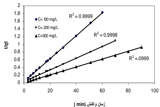
شکل ۵- سینتیک درجه دو کاذب جذب سیانید توسط کربن فعال به دست آمده از هسته خرما (pH اولیه محلول  $9$ ، دوز جاذب  $1/25\text{ g/L}$ )
