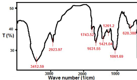
شکل ۱- طول موج FTIR کربن فعال اصلاح شده با هیدروکسید سدیم در طول موج های  $4000 \text{ cm}^{-1}$  تا  $400 \text{ cm}^{-1}$
