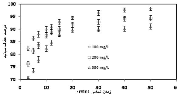
شکل ۴- تأثیر غلظت‌های اولیه سیانید بر درصد حذف آن توسط کربن فعال اصلاح شده با هیدروکسید سدیم (pH اولیه محلول ۹، دوز جاذب ۱/۲۵g/L، زمان تماس ۶۰ دقیقه)
