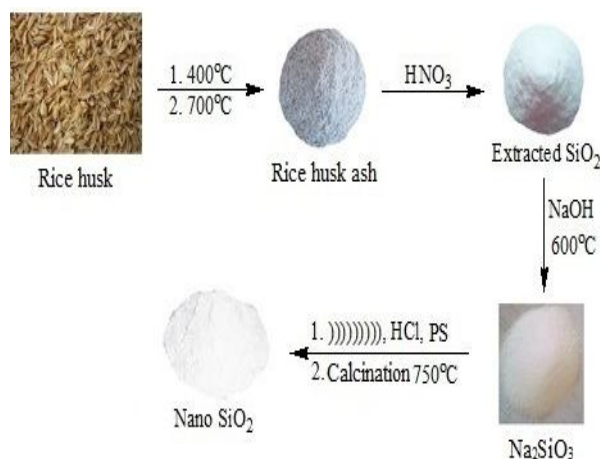
شکل 1- سنتز نانوذرات سیلیکات از پوسته برنج
