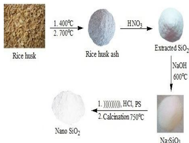
شکل 1- سنتز نانوذرات سیلیکات از پوسته برنج
