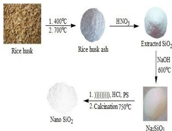
شکل 1- سنتز نانوذرات سیلیکات از پوسته برنج
