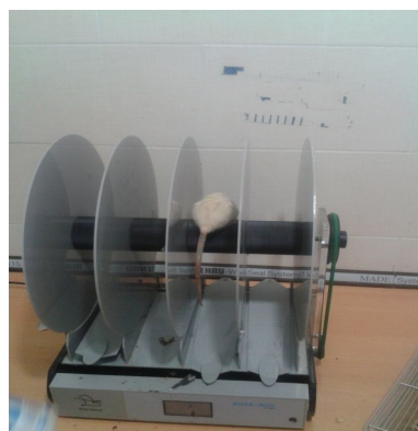
شکل 1- دستگاه استوانه چرخان (Rotarod) برای بررسی فعالیت حرکتی حیوانات
